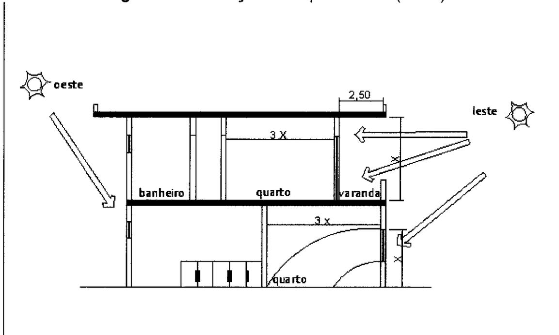
Figura 06: Ventilação – Prisma de ventilação (art.93)
